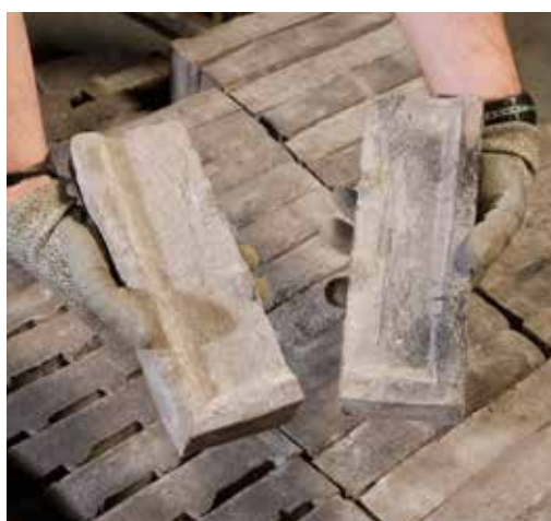
Er zijn stenen met een linker en met een rechter kopkant. Zo zijn er geen speciale hoekstenen nodig.
